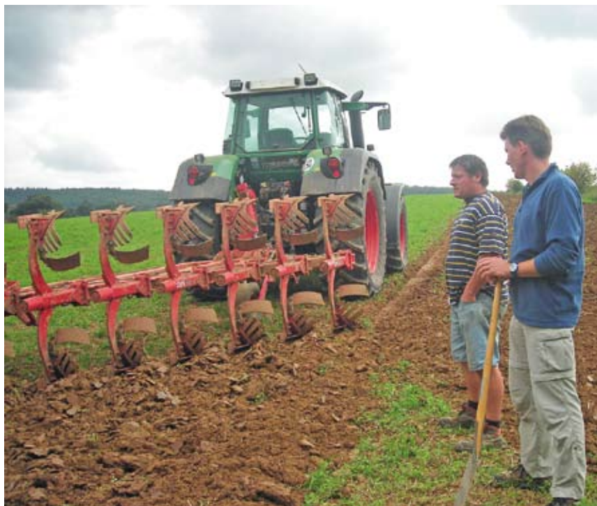
Beim Ovlac-Schälppflug wird „onland“, das heißt neben der Pflugfurche, gefahren.
